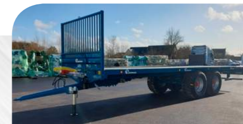
Essieu suspendu sur lame de ressort Freinage mixte
