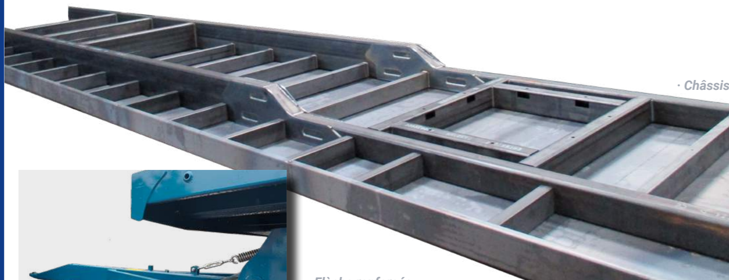
· Flèche renforcée sur 26T suspendue par ressorts réglables en hauteur 2 positions
